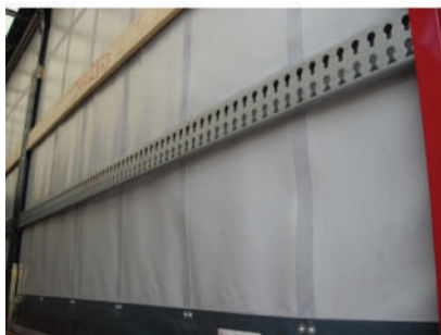
27. attēls. Alumīnija liste ar bloķējošajiem stienī paredzētiem caurumiem
