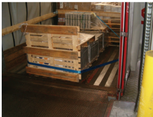
75. attēls. Sistēma jaukta tipa kravas nostiprināšanai pret aizmugurējo bortu
