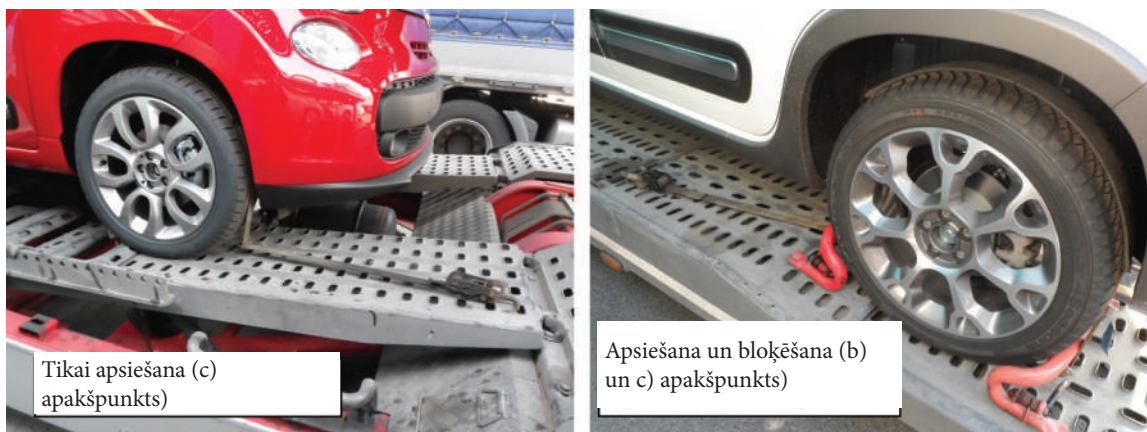
57. attēls. Nostiprināšanas sistēmas automobiļu pārvadāšanai
