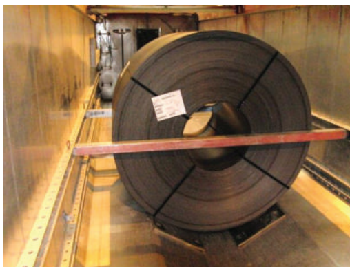
61. attēls. Spoles pārvadāšana īpašā transportlīdzeklī
