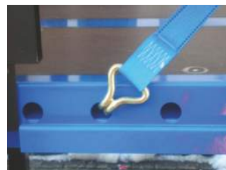
13. attēls. Stiprinājuma caurums sānu profilā
