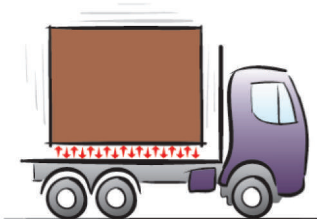
3. attēls Vertikālas vibrācijas braukšanas laikā
