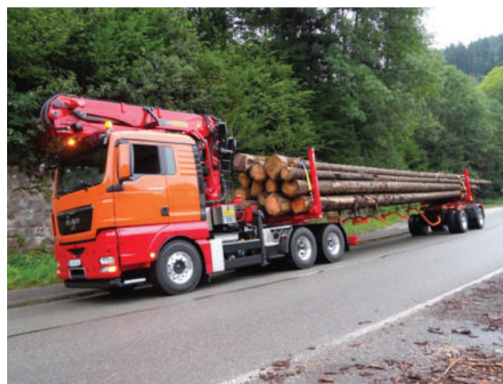
53. attēls. Pilna garuma koku pārvadāšana
