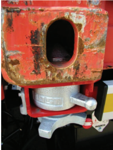
17. attēls. Pagriežamais aizslēgs un konteiners
