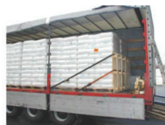
39. attēls. Atspelveida apsiešana, izmantojot paliktņus
