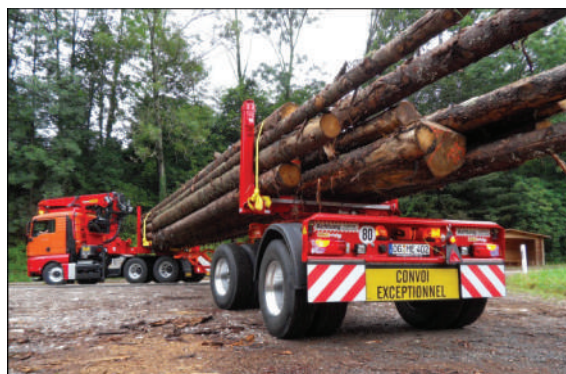
54. attēls. Pilna garuma koku nostiprināšana
