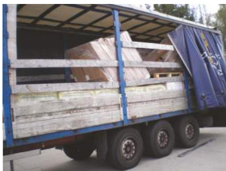
19. attēls. Nepietekami nostiprināta krava, izmantojot tikai elastīgu ietinamo plēvi
