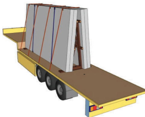
48. attēls. Nostiprināšanas metožu kombinācija — bloķēšana, A formas rāmis, aptišana un pārsiešana no augšas
