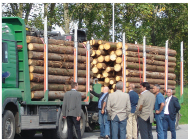
51. attēls. Apaļkoku nostiprināšana
