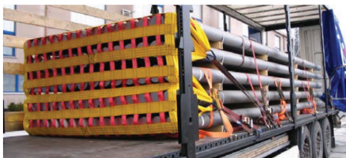
32. attēls. Nostiprināšana ar tīklu un tiešajām saitēm virzienā uz priekšu
