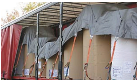
31. attēls. Nostiprināšana ar tentu
