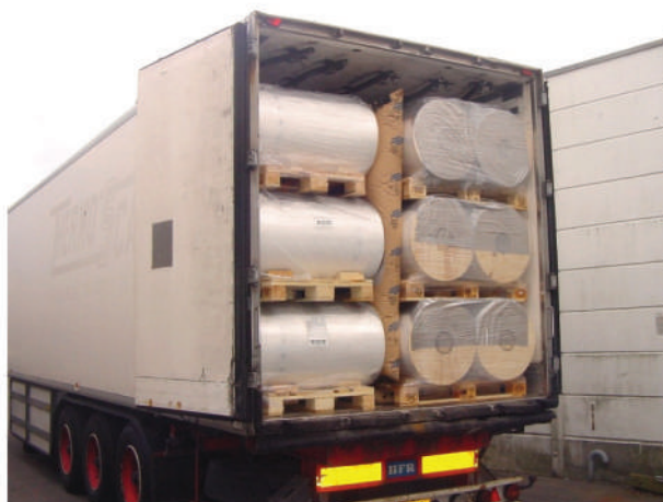
28. attēls. Pildmateriāls starp kravas rindām
