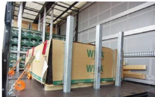
7. attēls. Statņi, ko izmanto bloķēšanai virzienā uz priekšu
